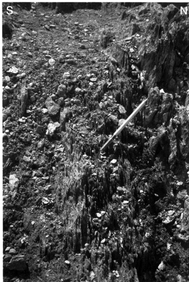
Fig. 6. Detailansicht der Störzone Nr. 20 (nach Frei 1999, westlich des geodätischen Messpunktes M2). Innerhalb des verschieferten Gesteinsmaterials in der Bildmitte treten feinste Bänder von kohäsionslosem "Gesteinsmehl" auf.
