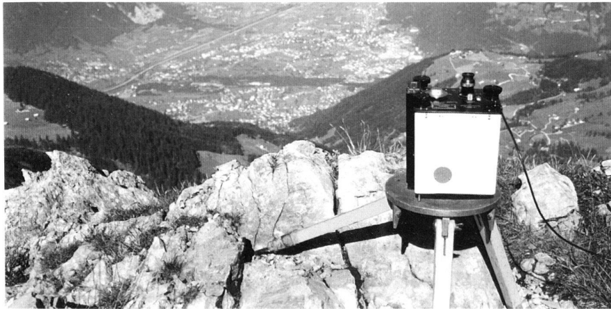
Fig. 3. Situation typique d'un gravimètre (Lacoste & Romberg, type G, n°479, IGL) dans un relief alpin, ici la région d'Altdorf depuis Schorren (alt. 2046 m) dans vallée de la Reuss (photo B. Dumont)
