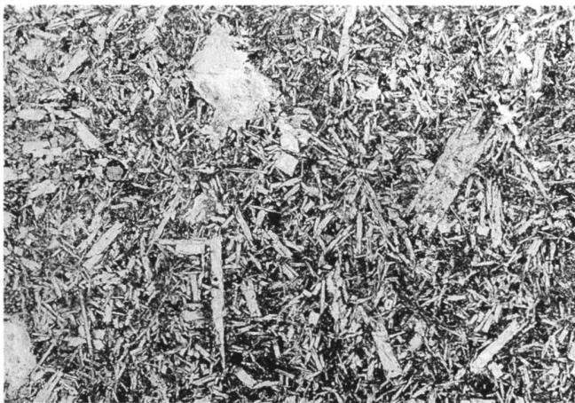
Fig. 5. Gefügebild einer Diabaskomponente (siehe Ob2 in Tabelle 1). Fein intersertales bis porphyrische Albitgefüge. Grundmasse aus Chlorit, Pumpellyit, Titanit. Bildbreite 4 mm.
