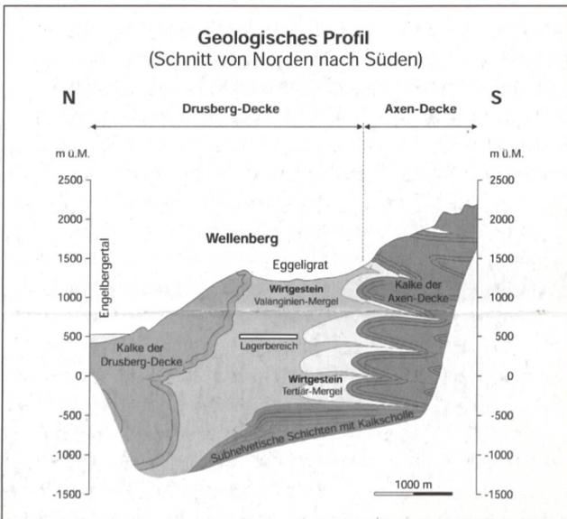
Profil durch den Wellenberg, senkrecht zu den geologischen Hauptstrukturen. Das Wirtgestein, in welches das Lager auf Talniveau zu liegen käme, besteht aus Valanginien- und Tertiär-Mergeln. Aufgrund bisheriger Untersuchungen ist dieses tonige Gestein sehr wasserdicht. Die im potenziellen Lagerbereich vorgefundenen Spuren von Grundwasser sind sehr alt – sie sind weit mehr als zehntausend Jahren im Berg eingeschlossen und ohne Kontakt zur Erdoberfläche.
