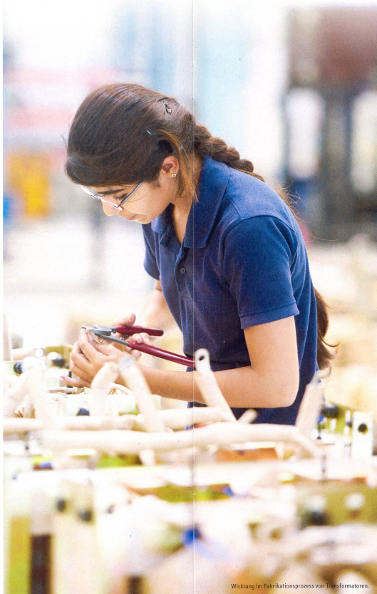
Wicklung im Fabrikationsprozess von Transformatoren.
