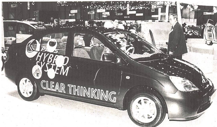
La Toyota Prius est la première voiture hybride de série. En combinant essence et électricité, elle consomme environ 5 l/100 km.
