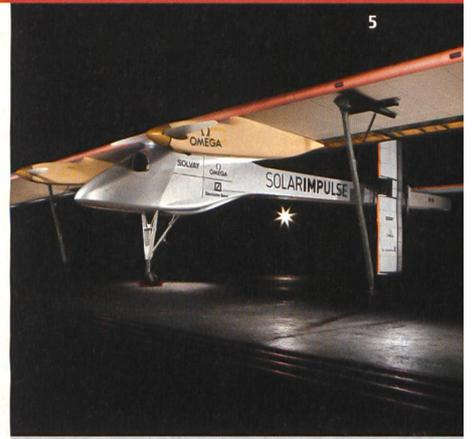
ailes sans fin et sur le stabilisateur horizontal sont réparties 11 628 cellules solaires en silicium monocristallin qui viendront alimenter en énergie les quatre moteurs de dix chevaux chacun de l'avion. Pour permettre le vol de nuit, de l'énergie sera stockée pendant la journée dans les 400 kilos de batteries au lithium polymère embarquées. Une structure ultra légère en matériaux composites vient compléter ce petit bijou d'innovation qu'est le Solar Impulse HB-SIA.
