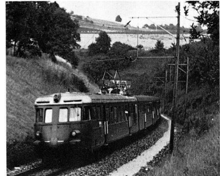
Moderner Triebwagenzug von 1955 (Schweiz). Leichtstahlwagen befuhren zwar schon 1939 einige Strecken, wurden aber erst nach dem Kriege richtig eingesetzt. Aus: Lesegesellschaft Bülach. 100 Jahre Eisenbahn Winterthur-Koblentz. (Bülach), 1976;
