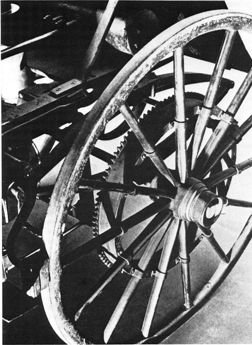
Detailansicht des ersten Wagens von DAIMLER (1887). Am Hinterrad wurde eine einfache Zahn- radübertragung angebracht. Aus: ICKX, J. Ainsi naquit l'automobile. Lausanne, s.a.
