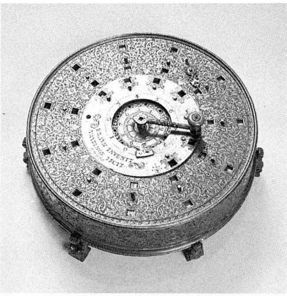
Vier-Spezies-Rechenmaschine von Antonius Braun um 1750 in ornamentiertem Messinggehäuse, im Deutschen Museum. Durchmesser 19,5 cm. Drei Zifferscheiben herausgehoben.
