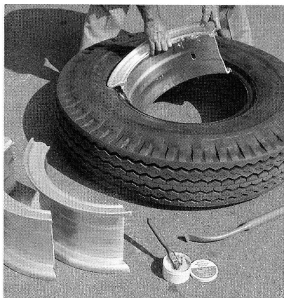
Die dreigeteilte TRILEX-Felge lässt sich mit einfachen Bordwerkzeugen leicht und gefahrlos montieren.
