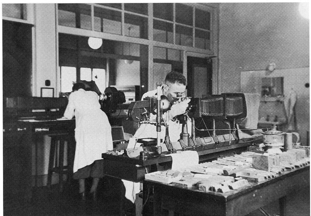
Kamera für metallographische Aufnahmen in einem Labor der Vereinigte Stahlwerke AG 1930er Jahre
