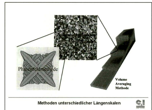
Simulationsmethoden für unterschiedliche Längenskalen (von rechts nach links: cm-Bereich, mm-Bereich (10 bis 1000 \mu\text{m} ), \mu\text{m} -Bereich (< 10 \mu\text{m} )).
