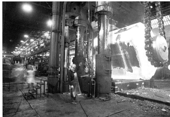
Der Rohblock wurde auf einem grossflächigen Untersattel auf der 8000-Tonnen-Pressen gereckt (Bildnachweis: privat).
