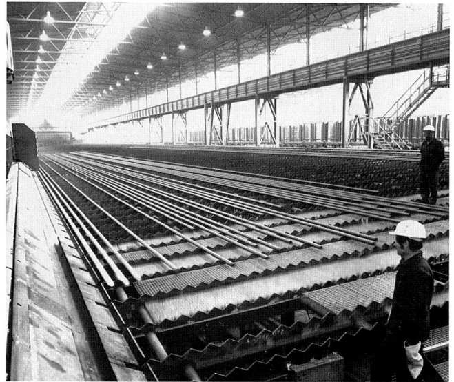
Bild 30: Kühlbett mit bis zu 160 m langen Rohren.
