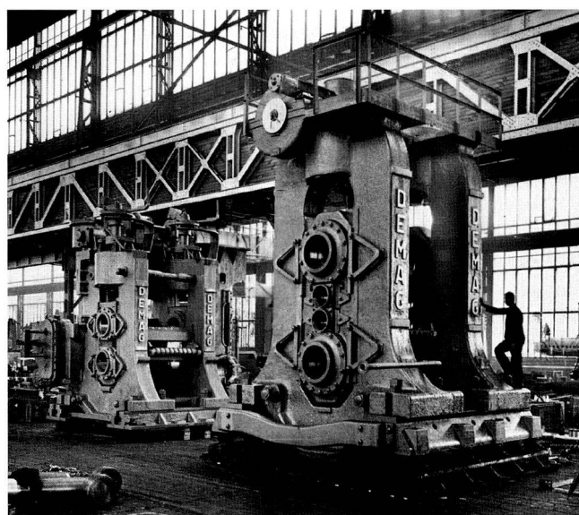
Vor- und Fertiggerüst (rechts) der Warmbreitbandstrasse während der Montage, 1937.
