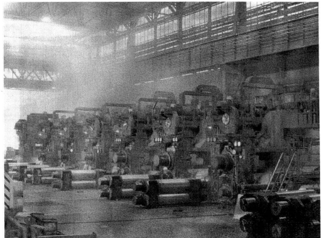
Bild 8: Warmbreitbandstrasse der VOEST-ALPINE.
