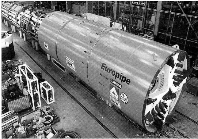
Bild 8: Europipe – Vortriebsmaschine bei Werkmontage, Schwanau, Deutschland. (Foto: Herrenknecht AG)
