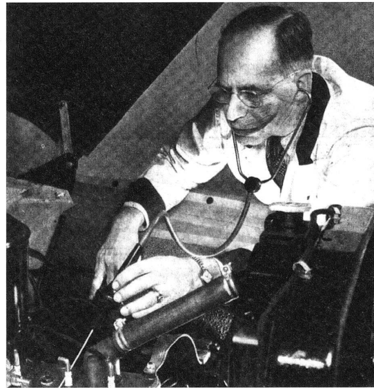
Mit dem Mechanikerstethoskop konnten gezielt einzelne Stellen am Motor abgehört werden.
