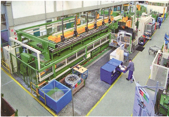
Anlage zum Profilräumen.
