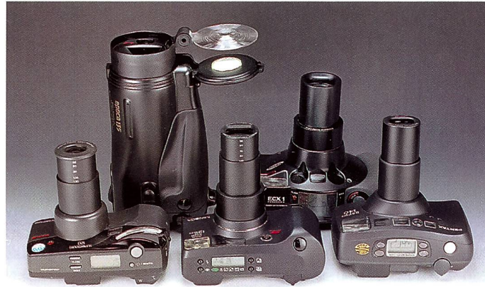
Mehr oder weniger kompakt präsentieren sich die Zoomkompakten, besonders mit ausgefahrenem Zoom. In dieser Position sind die Kameras übrigens sehr empfindlich gegen jede Krafteinwirkung.
