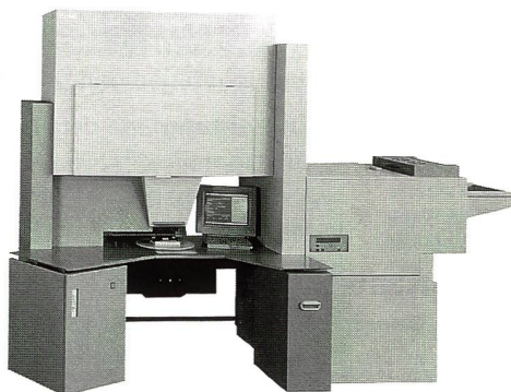
Durst Visolab verarbeitet KB- und Rollfilme zu Bildgrössen von 9x9 bis 30x45 cm. Die Stundenleistung liegt bei 720 Bildern 9x13 cm im Automatikbetrieb.
