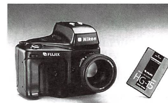
Bei der Spiegelreflex-Digitalkamera Fujiflex DS-505 / DS-515 sorgt ein Kondensor-Element dafür, dass das gesamte Sucherfeld auf dem CCD-Chip abgebildet wird. Bereits vorhandene Objektive können dadurch wie bisher eingesetzt werden. Die schnell auswechselbaren PC-Cards bieten bei einer Speicherkapazität von 15 MB Platz für bis zu 84 Bilder.
