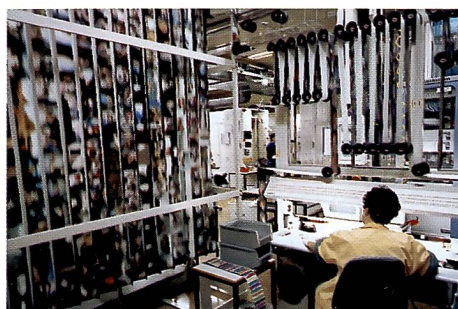
Rundum Bilder! Am Kontrolltisch wird jedes Bild visuell inspiziert. Geübte Augen geben hier eventuelle Korrekturwerte ein.
