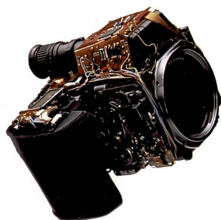
Die Elektronik sowie die wichtigsten mechanischen Teile sind um das Aluminium-Druckgussgehäuse herum angeordnet und werden von einer glasfaserverstärkten Polycarbonathülle geschützt.
