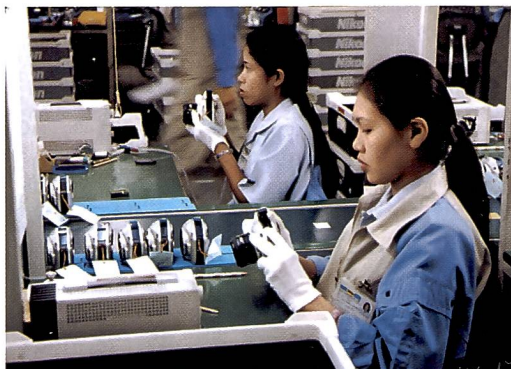
Eine Pronea S besteht aus rund 400 Einzelteilen, die in Baugruppen vormontiert werden und dann in die Montageabteilung kommen. Flinke Hände und höchste Konzentration sind hier gefragt.
