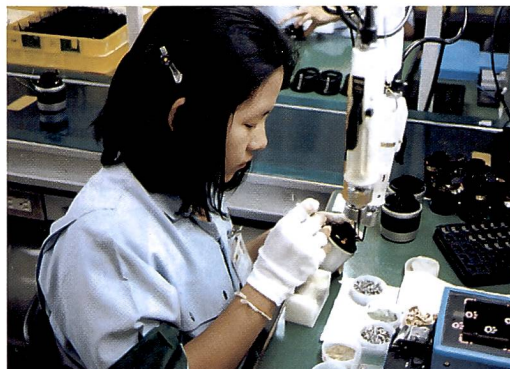
Beeindruckend bei der Pronea S-Herstellung in Thailand ist der hohe Anteil an manueller Arbeit sowie der verhältnismässig grosse Kontrollaufwand, um dem hohen Qualitätsanspruch nachzukommen.
