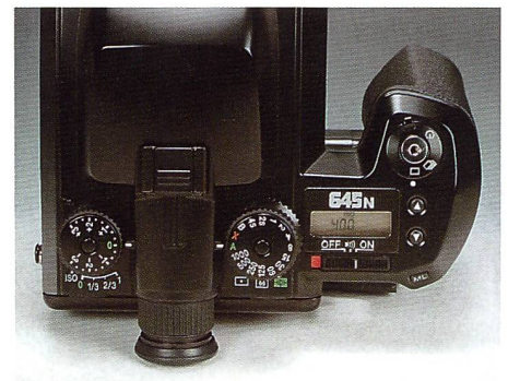
Pentax 645N: Logischer Aufbau der Bedienungselemente, ähnlich KB-Spiegelreflex.
