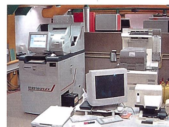
Bei Pro Ciné werden die digitalen Daten entweder auf einem Noritsu oder auf dem neuen, digitalen Gretag Masterlab ausbelichtet. Letzteres ist bei Pro Ciné seit Wochen im Feldtest.
