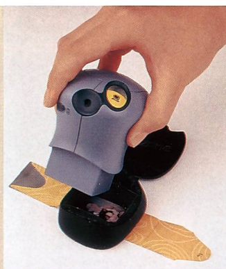
«Webster» heisst der neue Handscanner, mit dem die kleinen Polaroid i-zone Bilder digitalisiert und gleich ins Internet gestellt werden können.
