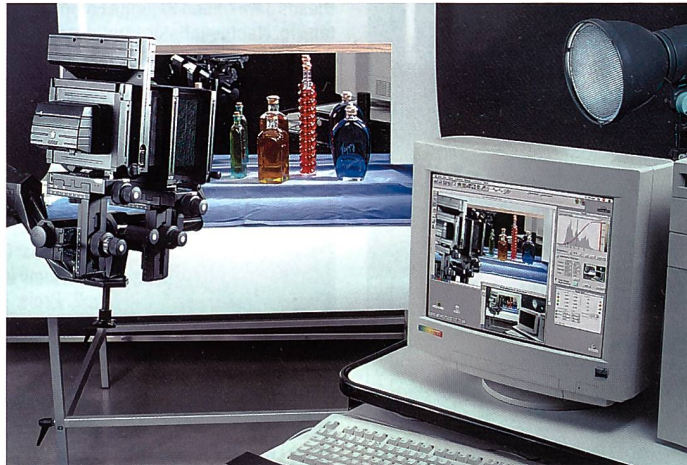
Das professionelle Fotostudio besteht aus der Kombination von Fachkamera, Blenden- und Verschlusssteuerung per Computer mit integriertem LCD-Verschluss und einem hochauflösenden Digitalrückteil. (Foto Sinar AG)
