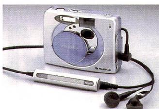
lösung 1600 x 1200 aufnimmt. Ebenfalls abgespeckt wurde das Objektiv, dessen Brennweite jetzt bei 38 mm (entsprechend Kleinbild) und Lichtstärke 1:4,8 liegen.
