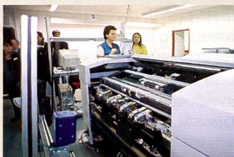
Kontrolle des Proofs, Datenbelichtung Computer to Plate.
