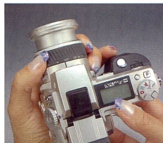
Die Zoomeinstellung erfolgt am Objektiv, wie bei analogen Kameras. Das ist schneller und handlicher als eine Zoomwippe.
