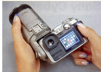
Der Kamerakörper schwenkt um das Objektiv.
