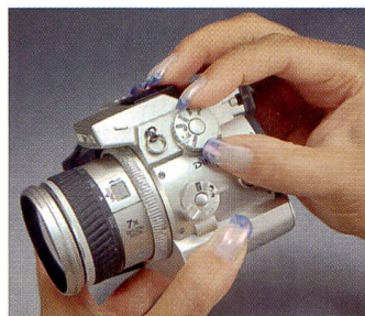
Weniger häufig benutzte Funktionen und Vorgaben werden an einem Einstellrad seitlich an der Minolta Dimage 7i gewählt.
