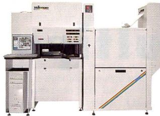
Als Bildformate stehen vom 9 x 13 bis zum 21 x 30 cm (A4) zur Verfügung. Die Durchlaufgeschwindigkeit liegt bei 1,5 bis 1,9 m/min, die Verarbeitungszeit bei 4,5 min. Der Tank fasst 21 l. Das DigiPro 8x12 misst 2,09 x 0,75 x 1,4 m.
