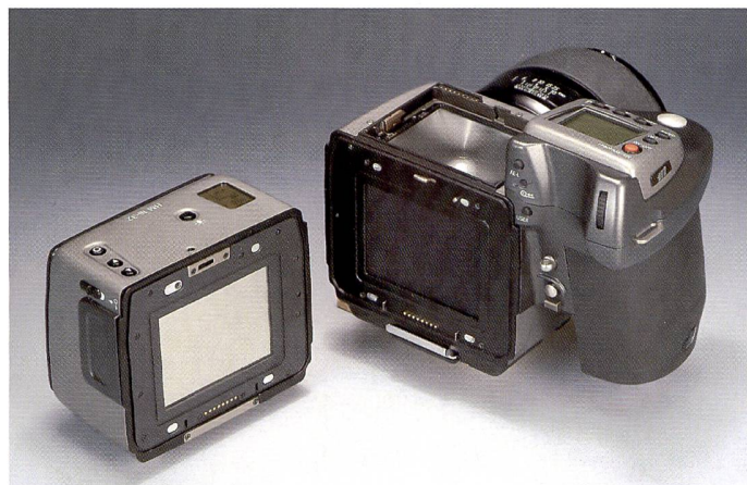
Kein Magazinschieber; das Rollo geht nicht verloren.
