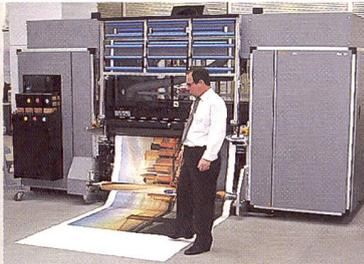
Durst Hochleistungs-Ink-Jet-Drucker Rho 160 druckt auf einer Breite bis 158 cm und ca. 45 m<sup>2</sup> pro Stunde.
