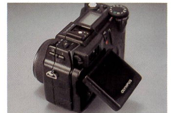
Olympus Camedia C-5050 Zoom: Zwei Steckplätze, Profi-Eigenschaften, Monitor lässt sich nach oben und unten schwenken.
