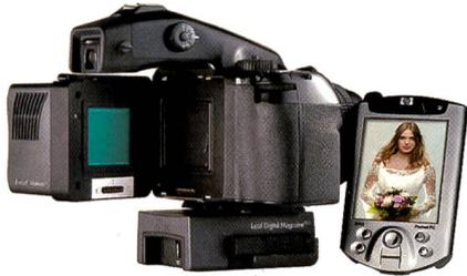
leo 22 ab September auf dem Markt erhältlich sein. Das Rückteil ist mit einem CCD-Sensor der Grösse 48 x 36 cm ausgestattet. Die Pixelzahl wird mit 4056 x 5356 (entspricht 22 Mpix) angegeben. Das Kamerarückteil ist sowohl für Studioapplikationen als auch für die Fotografie on location konzipiert und kann mit Mit-
