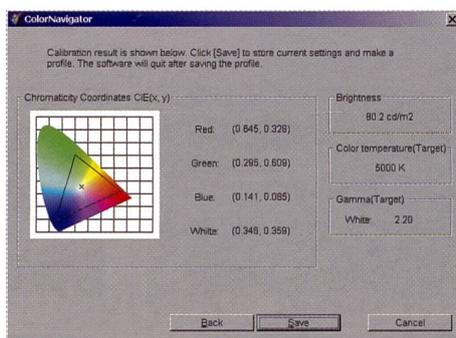
Kalibration auf Weisspunkt D50 (5000 K) und eine Luminanz von 80 cd/m<sup>2</sup> für die Druckvorstufe.
