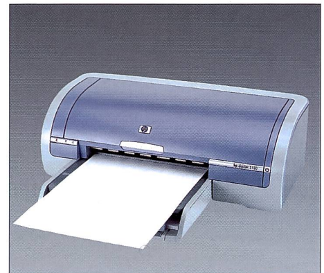
HP Deskjet 5150, Tintenstrahldrucker, 4800x 1200 dpi. Farbpatrone und Druckkopf nicht getrennt. Farbpatronen nicht einzeln austauschbar.
