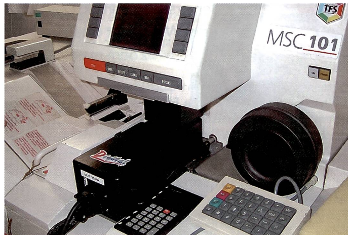
Die Belichtungseinheit wird in den Strahlengang des Minilabs eingesetzt.
