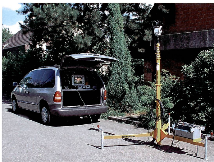
Die mobile Einheit, bestehend aus Mast, elektrischem Neigekopf und Steuerung hat Hans Auer selbst entwickelt.
