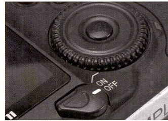
Der Hauptschalter der 5D ist etwas ungünstig positioniert.
