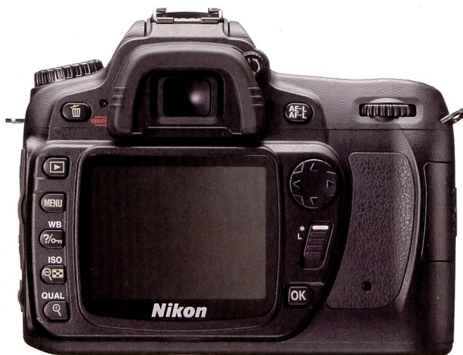
Das TFT-Display ist neu 6,4 cm gross mit einer Auflösung von 230'000 Pixel. Die Anordnung der Bedienelemente am Rand ist gleich geblieben.
