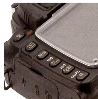
Nebst dem grösseren Display hinten unterscheidet sich die D80 von der D70s hauptsächlich durch die Auflösung von 10 Mpix.
