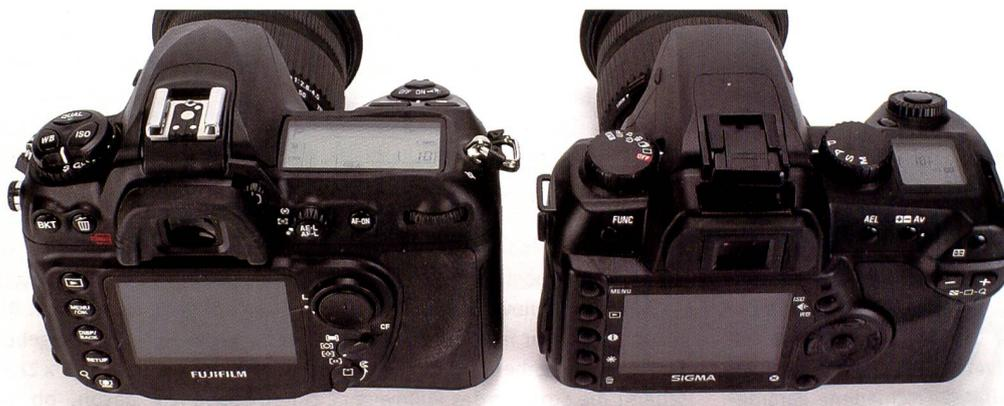
Während die beiden fast baugleichen Fujifilm S5 Pro und Nikon D200 professioneller anmuten, präsentiert sich die Sigma SD14 (rechts) übersichtlicher und einfacher in der Bedienung.
