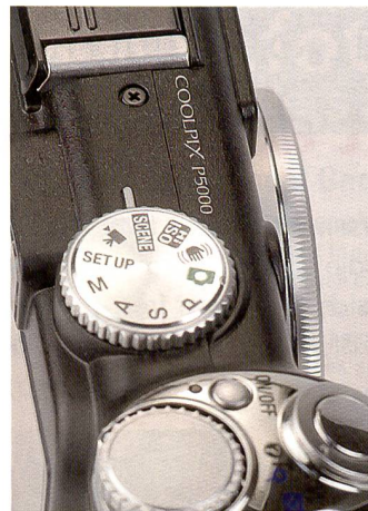
Nikons P5000 setzt auf ein zentrales Einstell-, sowie ein Wählrad.
