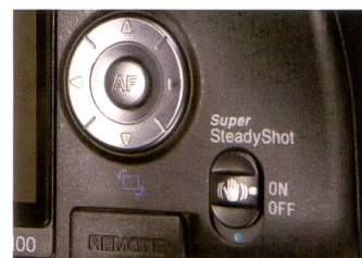
Mit dem Schalter unten rechts wird der Super Steady Shot aktiviert.
