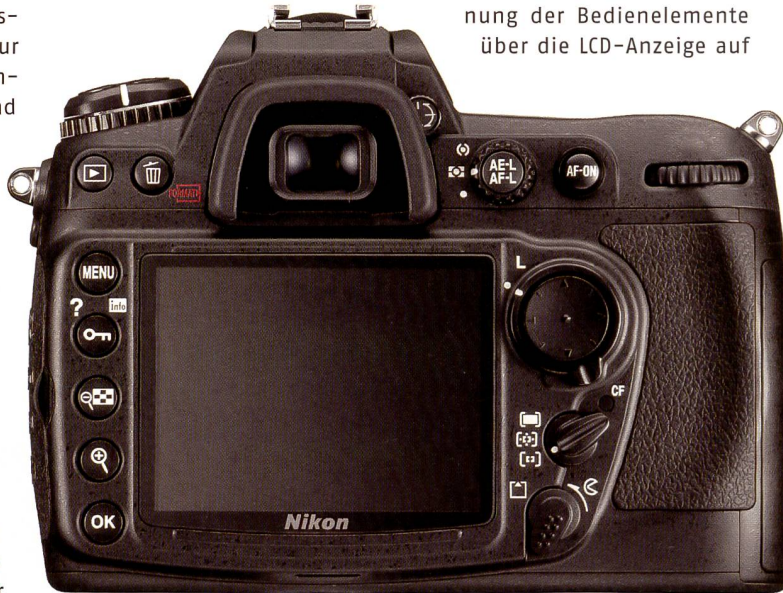
Die Rückenansicht der Nikon D300: Besonders beeindruckend ist das 3 Zoll LCD. Die 920'000 Bildpunkte entsprechen einer Vervierfachung gegenüber dem Vorgängermodell D200.
