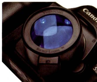
eine optimale Sensorbeleuchtung. Hochqualitatives K9 Glas mit MgF2 Beschichtung ergibt ein verzerrungsfreies und klares Bild des Sensors. Durch die sternförmige Anordnung der LEDs entsteht eine 3-dimensionale Abbildung, welche das Auffinden von Schmutz erleichtert.
