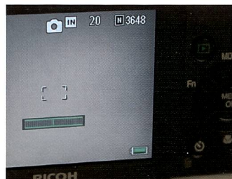
Als Besonderheit hat die Ricoh GR Digital II eine «Wasserwaage» eingebaut.
