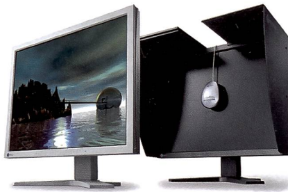
Eizo CG19: Bei Grafikern beliebt, da einziger Hardware-farbkalibrierbarer Monitor mit S-IPS-Panel für hohe Farbtreue. Jedoch relativ lange Reaktionszeit, deshalb für Multimedia weniger geeignet.
